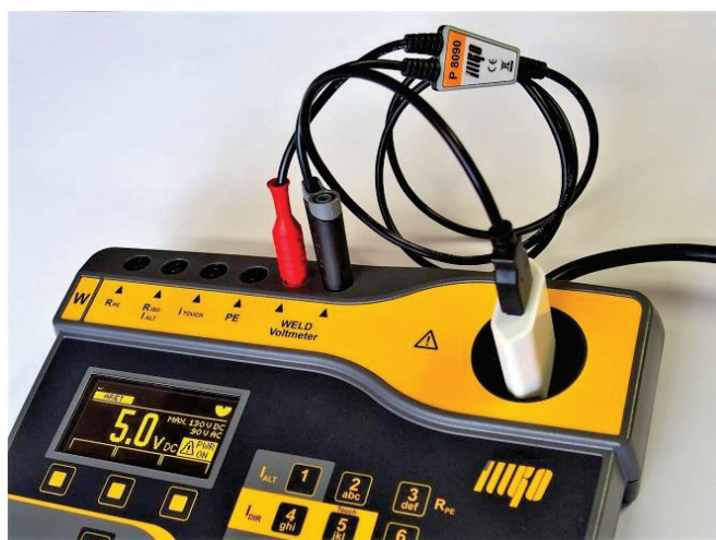
P 8090 – adaptér pro testování zdrojů SELV s USB konektorem (napětí, dotkový proud, izolační odpor)
