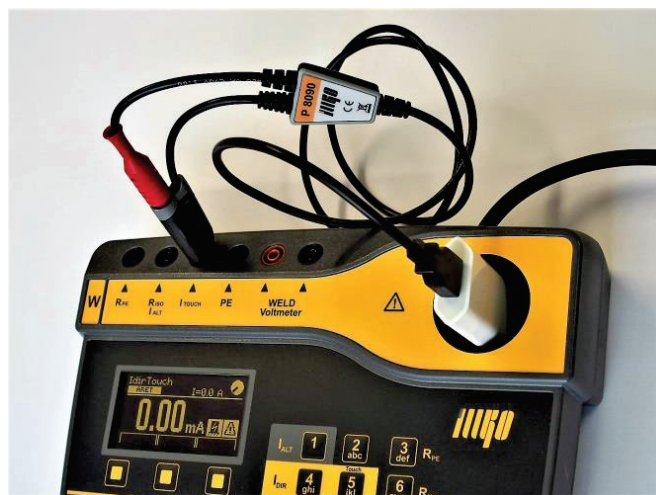
P 8090 – adaptér pro testování zdrojů SELV s USB konektorem (napětí, dotkový proud, izolační odpor)
