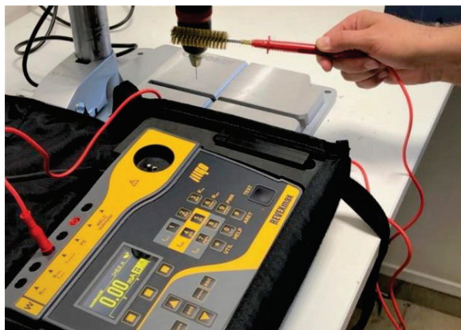
P 3070 – sonda pro snímání dotkového proudu z rotujících částí spotřebičů
