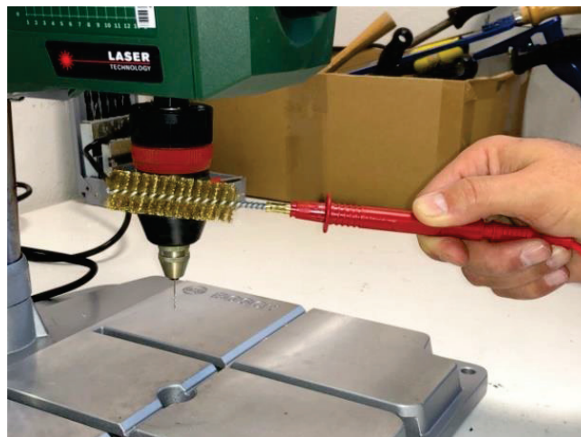
P 3070 – sonda pro snímání dotkového proudu z rotujících částí spotřebičů
