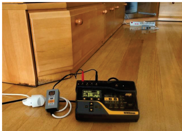
P 8080 - Adaptér pro testování odporu vodičů nepřístupně uložených prodlužovacích přívodů
